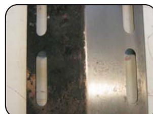
En flametamer (i grill 12213) som var mycket vålanvänd och täckt med marinad, matrester, smuts, ytrost etc. Högra sidan är rengjord och polerad.
