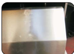
En uppolerad yta på grill 12713. Lätt yttlig rödoxid, fett och gulnader har avlägsnats
